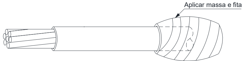
Figura 106 – Conexões e emendas – Rabicho
